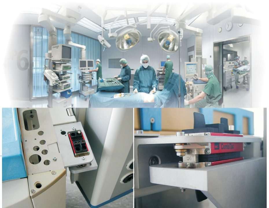
CombiTac permettant la connexions de chariots mobiles dans des salles d'opérations dans le domaine médical
