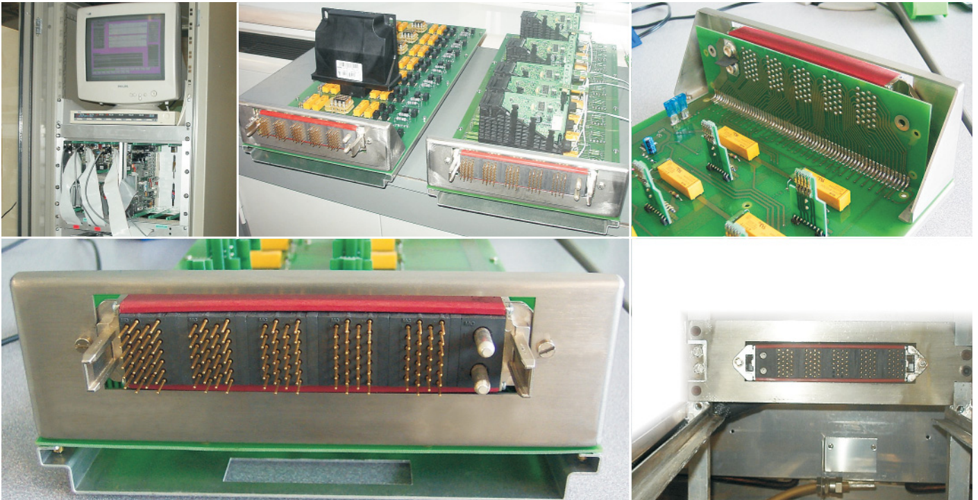
CombiTac in der Einschubtechnik, Belastungstest einer gedruckten Schaltung im Klimaschrank. 130 Steuer- und 2 Leistungs-Kontakte
