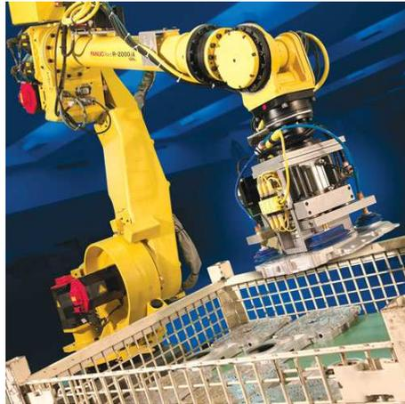
Figura 1.4: Sistema de *bin-picking* desenvolvido pela Fanuc.
