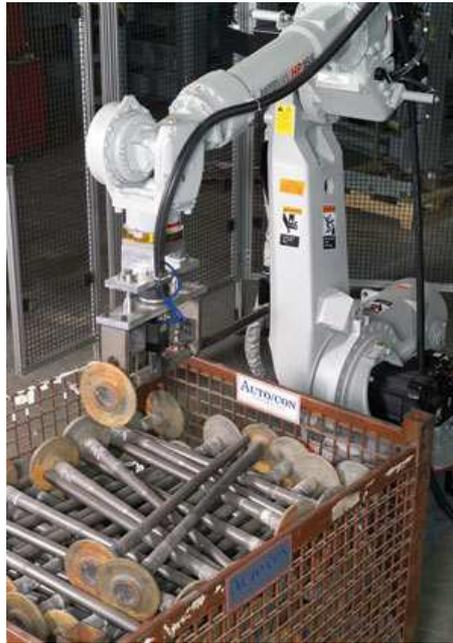
Figura 1.3: Sistema de *bin-picking* da Auto/Con Corp..
