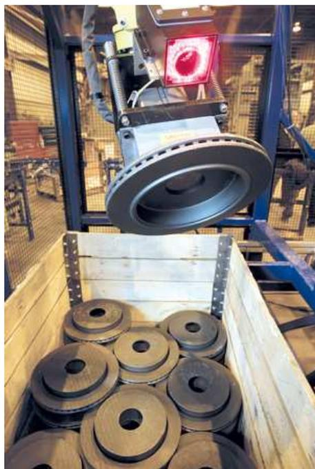
Figura 1.5: Sistema de *bin-picking* desenvolvido pela JMP, para a TRW Automotive.
