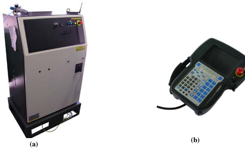
Figura 2.2 - (a) Controlador do robot; (b) Consola TP do robot.
