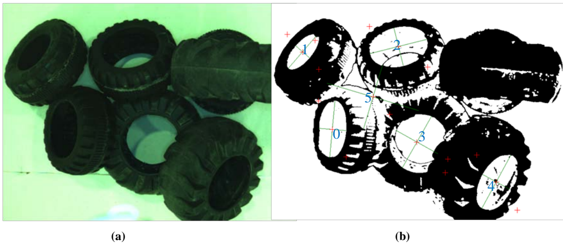
Figura 4.13 – (a) Imagem captada; (b) Ordenação dos objectos candidatos tendo em conta a combinação das suas propriedades.
