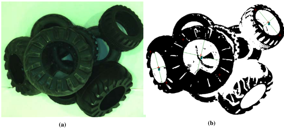
Figura 4.2 – (a) Imagem captada com iluminação localizada; (b) Respectiva imagem binarizada.
