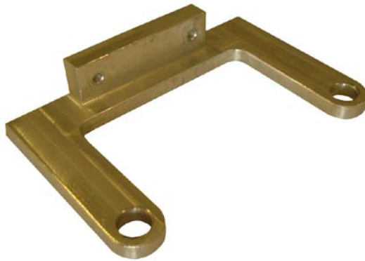
Figura 2.12 - Suporte desenvolvido para a fixação do sensor de distância.
