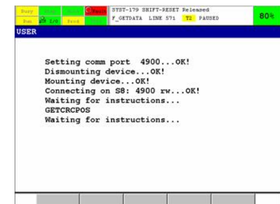
Figura 48 – robCOMM® – Ligação e execução de uma instrução
