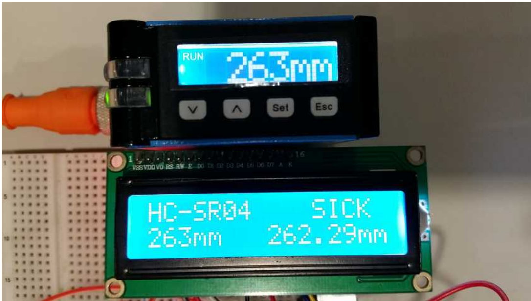
Figura 19: Display das leituras obtidas pelos 2 sensores e comparação entre a leitura obtida do sensor optoelectrónico e a apresentada por este.
