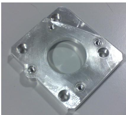
Figura 3.2: Redutor maquinado para acoplamento da borboleta motorizada
