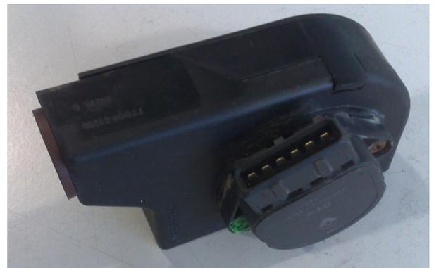
Figura 3.7: Potenciômetro pedal
