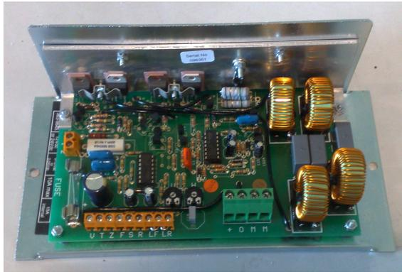
Figura 3.4: Controlador em posição de motores DC
