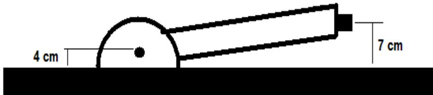
Ficou decidido que o melhor ponto de actuação na alavanca seria aos 16cm do eixo de rotação, deixando espaço para o condutor efectuar o accionamento manual.
