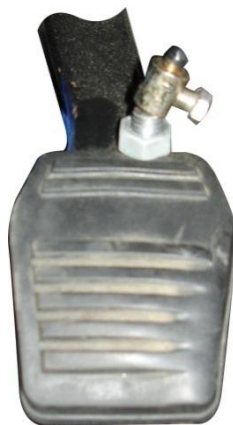
Figura 15 - Pedal do travão do AtlasCar
