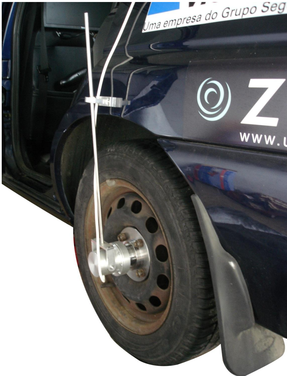
Figura 37 - Sistema de medição da velocidade montado no AtlasCar
