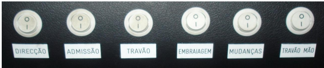
Figura 21 - Botões de comutação entre modo manual e automático
