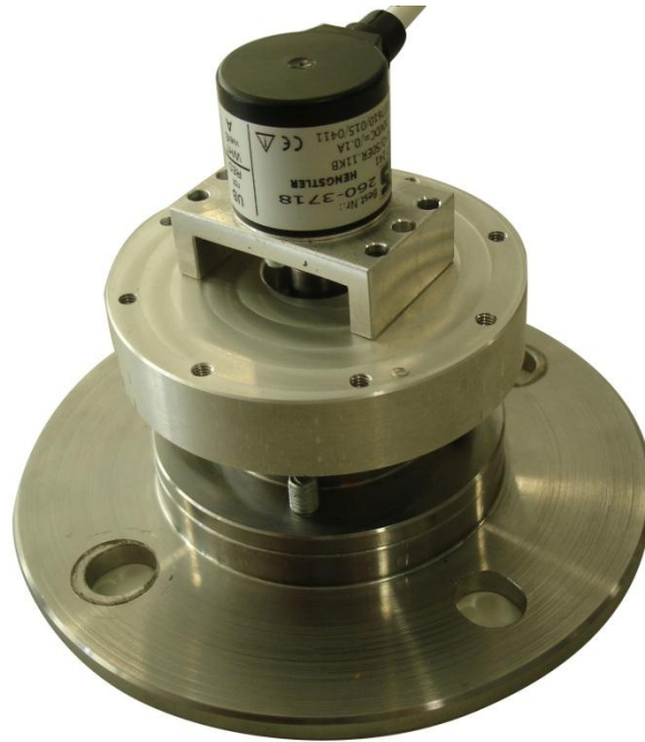
Figura 35 - Codificador montado no sistema de medição da velocidade
