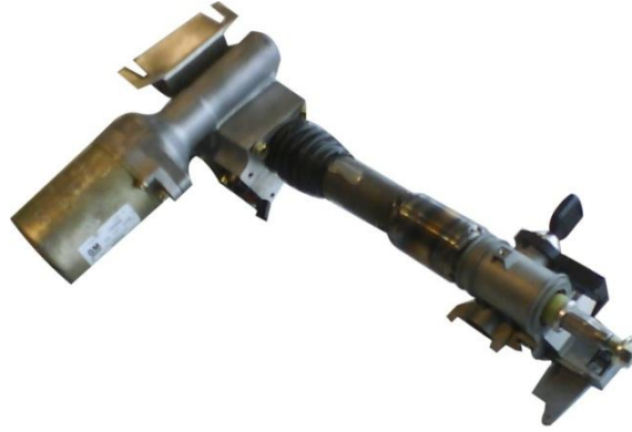
Figura 14 - Nova coluna de direcção instalada no AtlasCar
