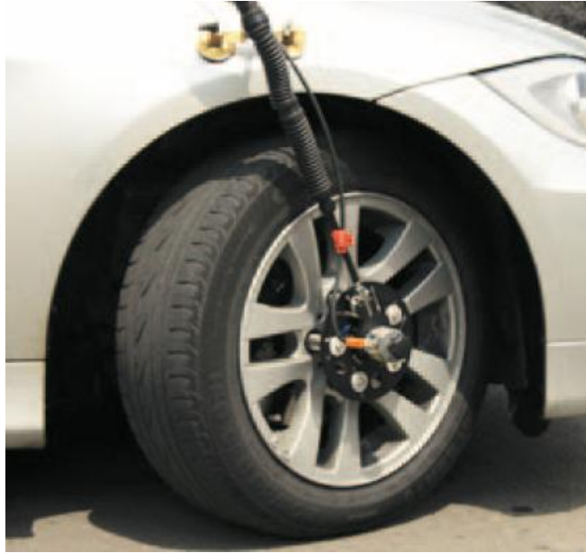
Figura 6- WPT Sensor montado num veículo
