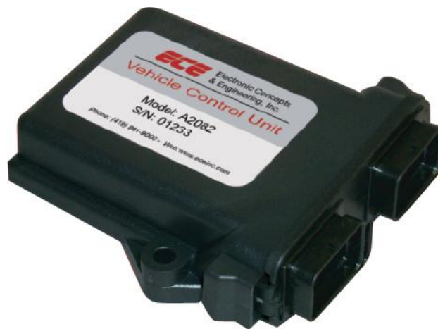
Figura 4 – Exemplo de centralina VCU Model: A2082
