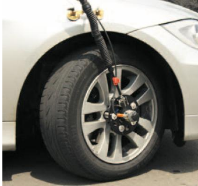
Figura 6- WPT Sensor montado num veículo
