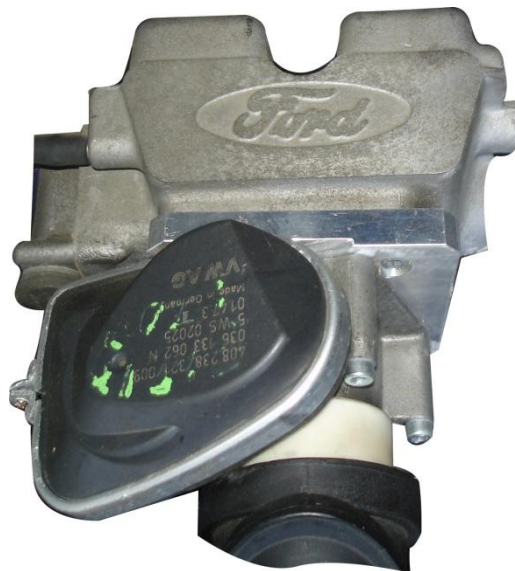
Figura 13 - Borboleta instalada no AtlasCar
