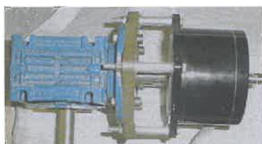
Figura N.º 19 – Acoplamento motor/redutor e suporte do motor
