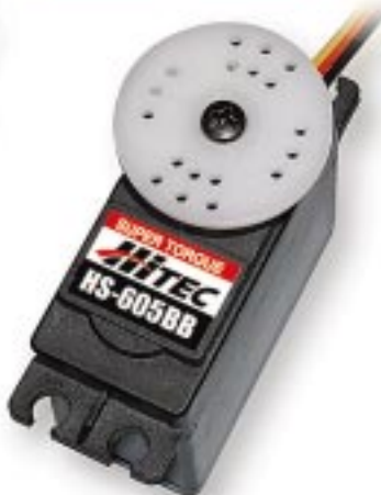
44.214 HS-605BB 44€ - 49g, tête sur 2 roulements - Pignons nylon hélicoïdaux - 41x20x40mm - 6,8 kg.cm, 0,13sec/60°
