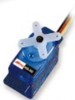
44.500 HS-50 34€ - Sub Micro 6,1g - 21x11x22mm - 0,6 kg.cm, 0,09sec/60°
