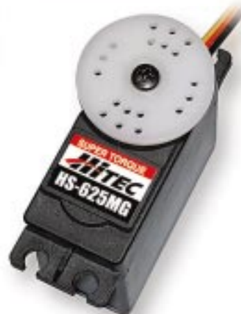
44.238 HS-625MG 59€ - 6,8 kg.cm, 0,15sec/60° 44.235 HS-645MG 59€ - 8,6 kg.cm, 0,20sec/60° - 55,2g 41x20x38mm - Pignons métal - 1 pignon métal/nylon - Tête sur 2 roulements
