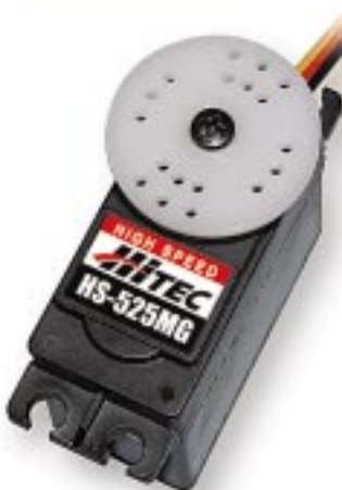
44.224 HS-525BB 47€ 44.221 HS-525MG 57€ - 44,5g (MG : 50,8g) - MG : pignons métal - 4,1 kg.cm, 0,12sec/60° 44.225 HS-545BB 47€ - 44,5g, 5,5 kg.cm, 0,17sec/60° - Tête sur 1rt, moteur 5 pôles - 40x20x36mm
