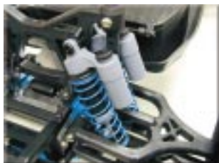
Double amortisseurs hydrauliques pour chaque bras de suspension
