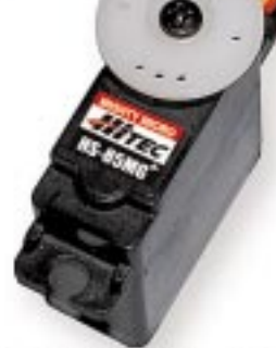
44.432 HS-85BB+ 33€ - 1 roulement, support pour planeur 44.337 HS-85MG+ 45€ - 19,2g (MG+ : 21,9g) - MG+ : pignons métal - 29x13x30mm - 3,5 kg.cm, 0,14sec/60°
