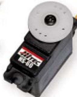
44.227 HS-60 34€ - Super Micro 13,5g - Support pour planeur - 26x13x24mm - 1,3 kg.cm, 0,16sec/60°
