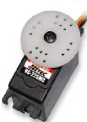
44.433 HS-225BB 34€ 44.438 HS-225MG 44€ - 27g (MG : 31g) - MG : pignons métal - Tête sur 1 roulement - 32x17x31mm - 4,8 kg.cm, 0,11sec/60°
