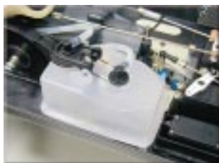
Réservoir grande capacité avec double alimentation anti-calage
