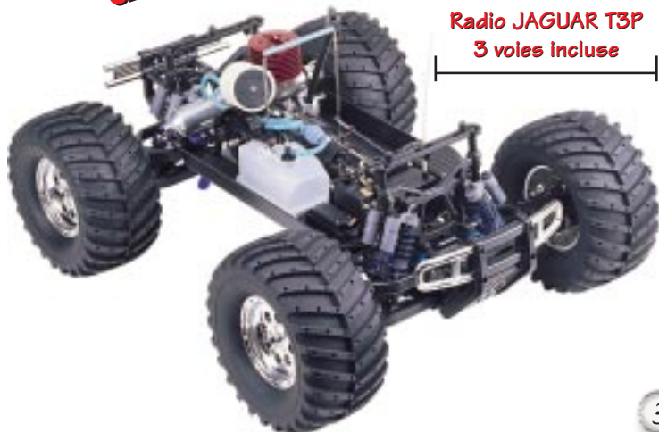
Châssis poutre aluminium extrudé avec renforts avant et arrière
