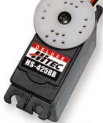
44.036 HS-422 20€ - Tête sur 2 lagues bronze 44.035 HS-425BB 25€ - Tête sur 2 roulements - 45,9g - 41x20x37mm - 4,1 kg.cm, 0,16sec/60°
