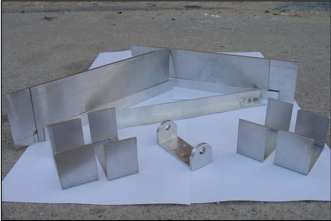
Figura 92 – Componentes não montados, juntas q5, q6 e ligação das pernas.
