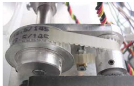
Fig. 28: Correia de transmissão aplicada a um servo.
