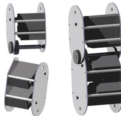
Fig. 2 - Estruturas do elo da perna e do elo da coxa, e montagem acoplada dos dois.
