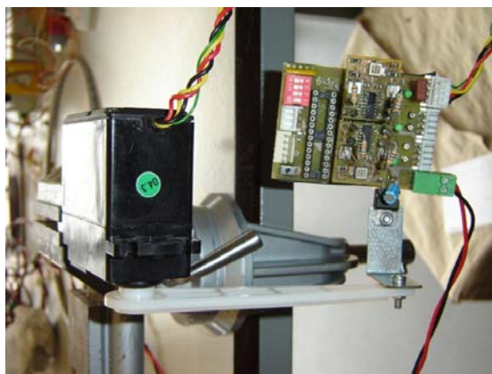
Fig. 3.9 - Teste dos acelerómetros (posição vertical +1g ou -90°)
