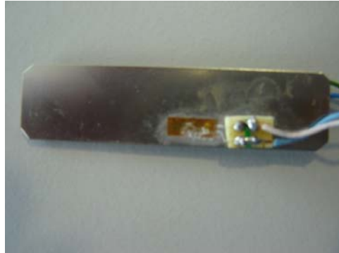
Fig. 2.15 - Dois sensores aplicado numa chapa de aço deformável.
