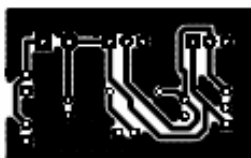
Placa de circuito impresso para a alimentação da electrónica
