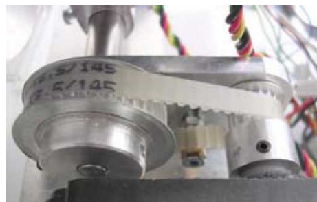
Fig. 28: Correia de transmissão aplicada a um servo.
