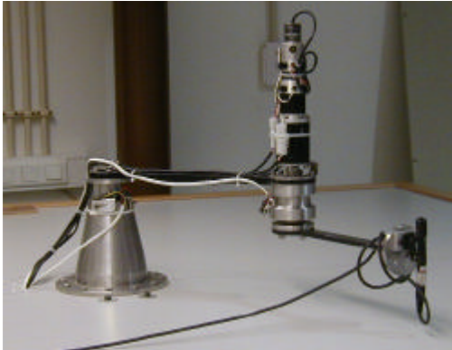
Fig. 3. Aparato experimental. Robô manipulador com câmara no elemento terminal, a olhar para cima.
