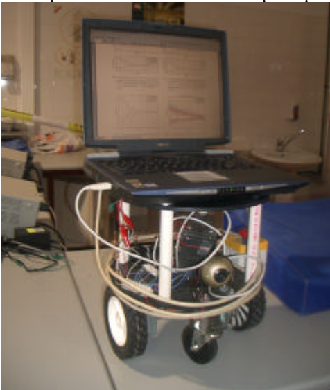
Fig .5. Plataforma experimental. Robô móvel, webcam e PC portátil.
