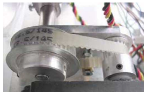
Fig. 28: Correia de transmissão aplicada a um servo.
