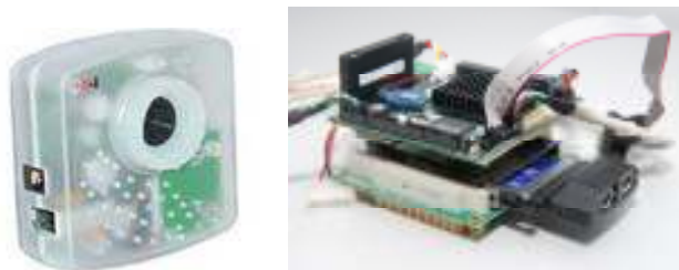
Figura 2. Câmara Unibrain Firewire e Módulo PCMCIA
