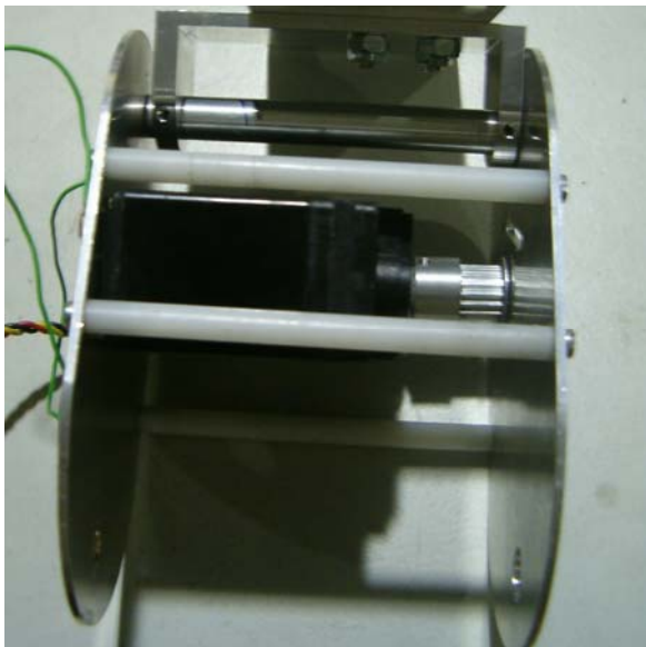
Fig. 70 – Montagem da estrutura da coxa.
