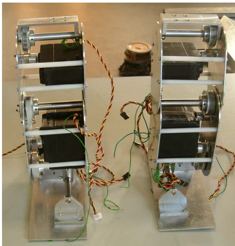
Fig. 39 – Montagem final das pernas, já com a transmissão por correia.
