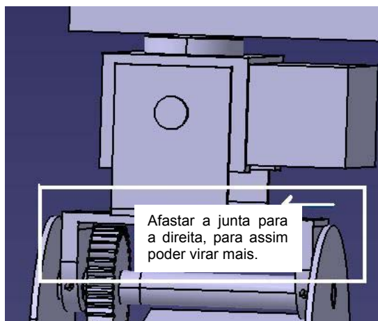
Fig. 24 – Alteração da junta esférica.
