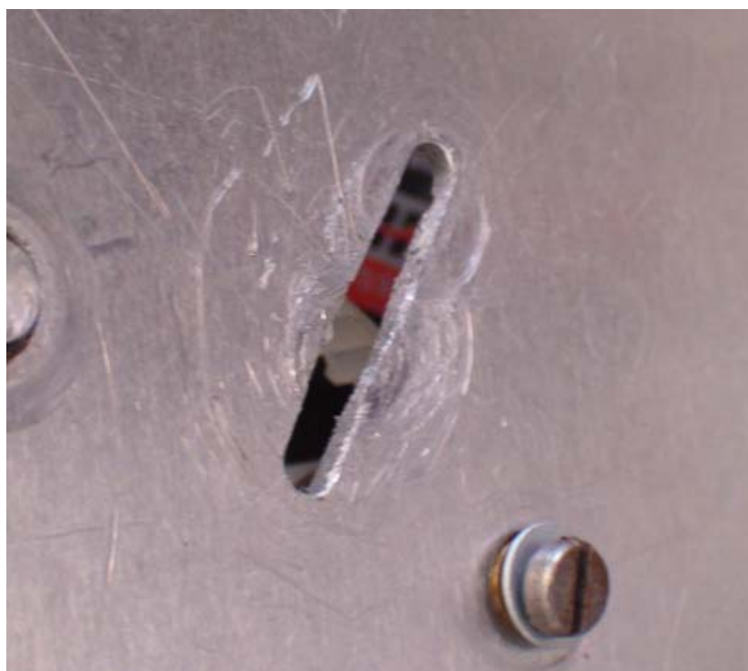
Fig. 94 – Chapa com o rasgo para os esticadores moídos.
