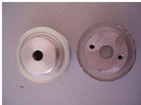
Fig. 104 – Polias comprada e polia depois de maquinada.
