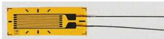
Fig. 116: Exemplo de um extensómetro típico.
