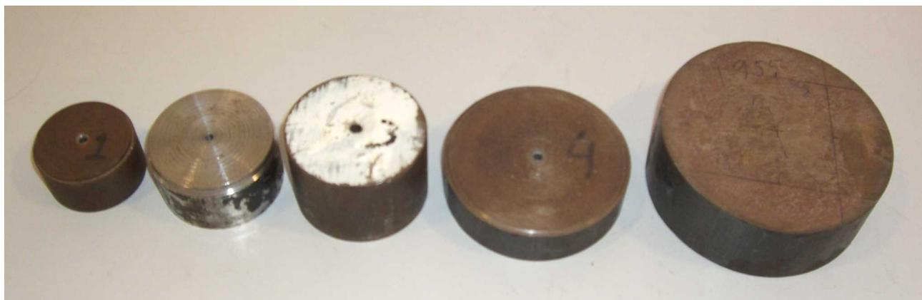
Fig. 21: Conjunto de massas a utilizar como carga no servo.
