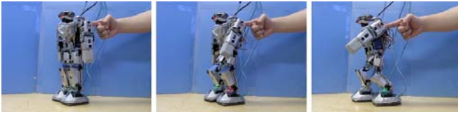
Fig. 17. Actual movement when human pushing back on left side
