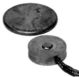
Figura 5.1: Células de carga miniatura de 5lbs usadas no robô humanóide.
