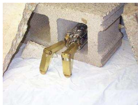
Figura 1.7: Exemplo de robô com locomoção por pernas: TerminatorBot da DARPA.
