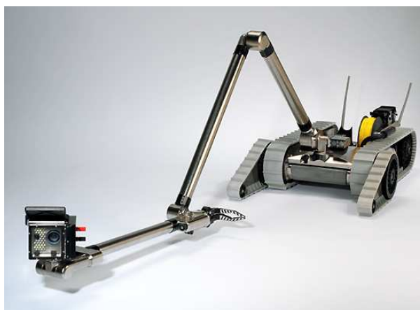
Figura 1.3: Robô de classe transportável: PackBot da iRobot
