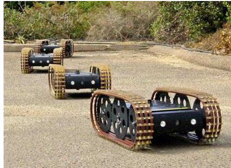
Figura 1.8: Exemplo de robô com geometria convencional: SPAWAR Urbot do CRASAR.
