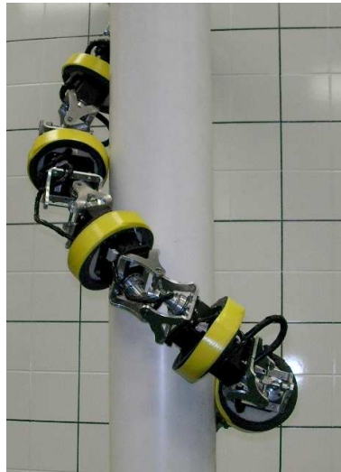
Figura 1.10: Exemplo de robô baseado em cobras: HyDRAS-Ascent da Virginia Tech.
