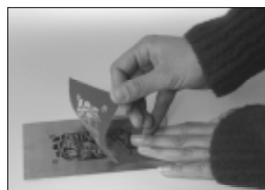
Dejar enfriar y separar la película PnP de la placa («pelar»).
