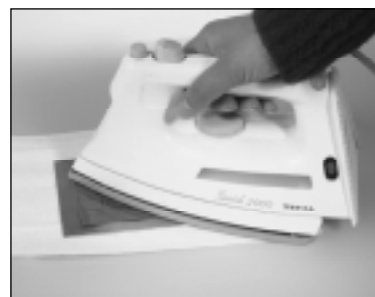
Pasar la plancha caliente (Nylon, de 170 a 190 °C) sobre la película, de manera que se caliente uniformemente.
