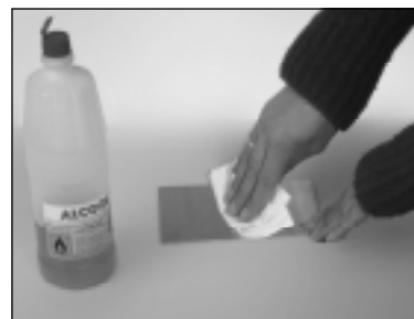
Limpiar cuidadosamente la placa cobreada con alcohol.
