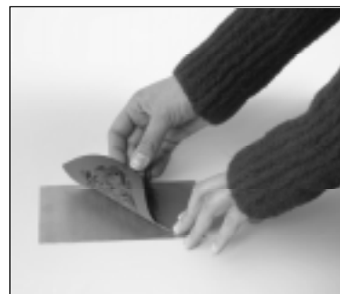
Apojar la película PnP de manera que la cara rugosa, que es la que contiene el «toner», esté en contacto con el cobre.
