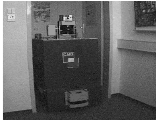
Abbildung 2: der autonome mobile Roboter ausgestattet mit dem 3D-Laserscanner
