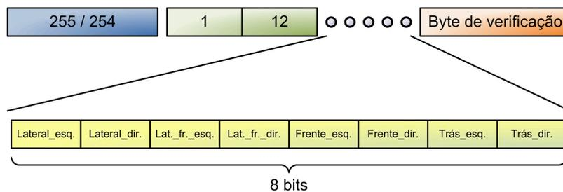
Figura 3.19: Mensagem de envio do estado dos sensores de contacto.
