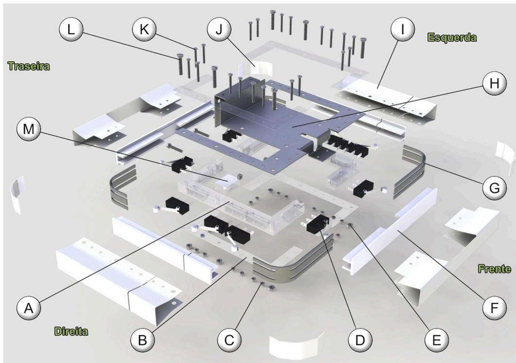
A- Suporte dos sensores de contacto; B- Tiras de PVC; C- Porcas M2; D- Sensores de contacto; E- Porcas M3; F- Barras de contacto; G- Cantos do pára-choques; H- Base do chassis; I- Telas de Latex; J- Telas de Latex para os cantos; K- Parafusos M2; L- Parafusos M3; M- Apoios esféricos com suporte.
