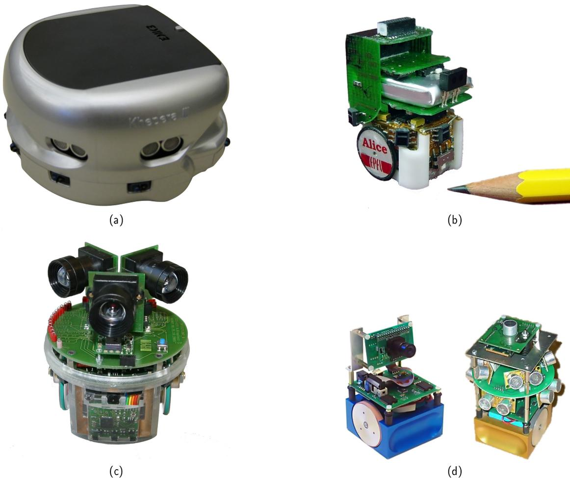
Figura 1.7: (a) Robô Khepera III da K-team Corporation; (b) Robô Alice desenvolvido na EPFL; (c) Robô e-puck também desenvolvido na EPFL; (d) Robô Miabot Pro da Merlin Systems Corp. Ltd.
