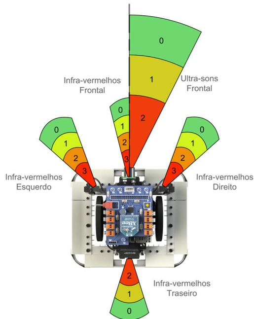
Figura 3.23: Representação dos níveis dos sensores de distância.
