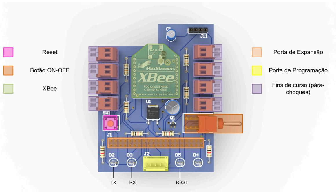
Figura 2.8: Placa de circuito auxiliar do SALbot.
