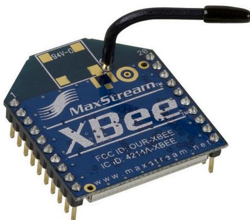
Figura 3.9: Módulo XBee XB24-AWI-001 da Digi®.
