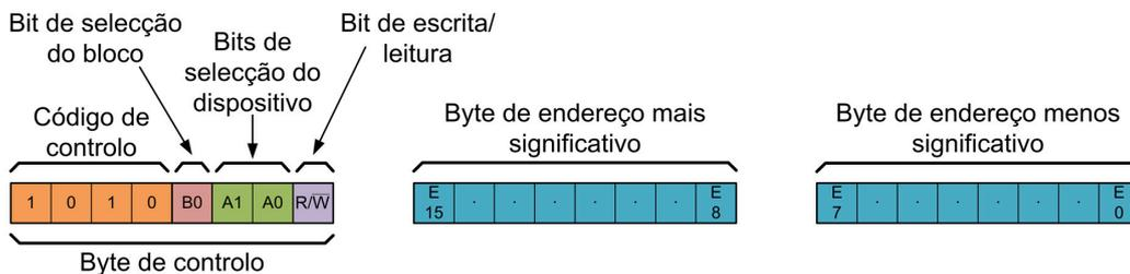
Figura 3.12: Composição da sequência de *bits* do endereçamento de uma mensagem por I<sup>2</sup>C™.
