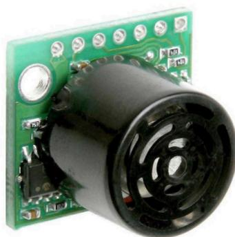
Figura 3.6: Sensor de distância ultra-sons LV-MaxSonar<sup>®</sup>-EZ0<sup>™</sup>.
