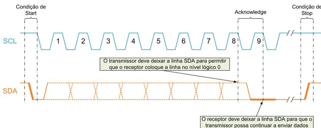
Figura 3.11: Composição da sequência de transferência de dados no I<sup>2</sup>C™.
