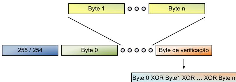
Figura 3.14: Descrição gráfica do *byte* de verificação.
