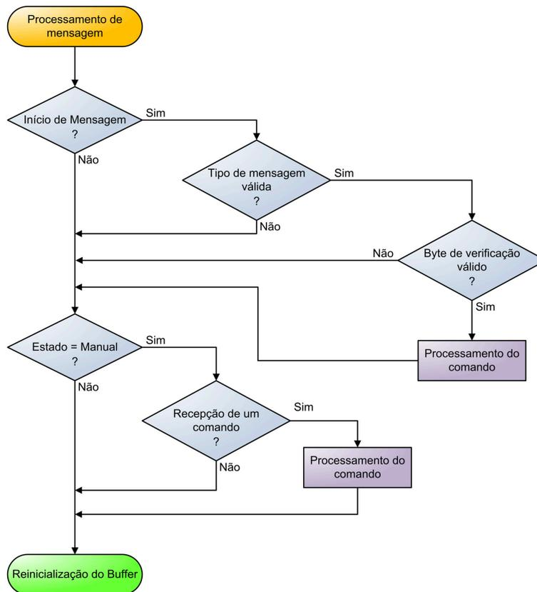
Figura 3.29: Fluxograma da rotina de Processamento de mensagens.
