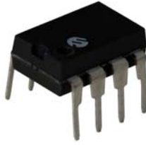
Figura 3.7: Unidade de EEPROM de interface série 24LC1025 da Microchip.
