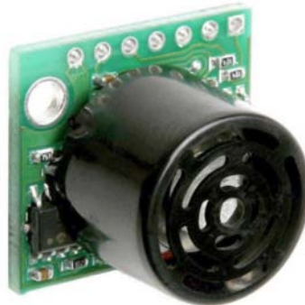
Figura 3.5: Sensor de distância ultra-sons LV-MaxSonar ® -EZ0 ™ .
