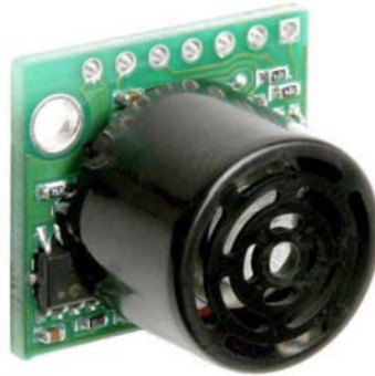
Figura 3.5: Sensor de distância ultra-sons LV-MaxSonar ® -EZ0 ™ .
