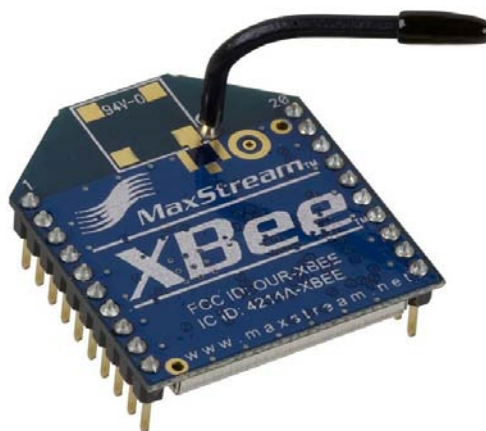
Figura 3.8: Módulo XBee XB24-AWI-001 da Digi®.
