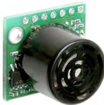
Figura 3.6: Sensor de distância ultra-sons LV-MaxSonar ® -EZ0 ™ .
