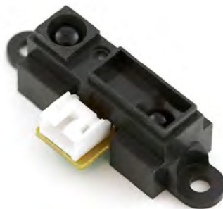
Figura 3.3: Sensor de distância infra-vermelhos Sharp GP2D120.
