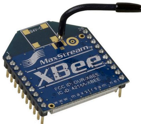
Figura 3.8: Módulo XBee XB24-AWI-001 da Digi®.
