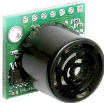
Figura 3.5: Sensor de distância ultra-sons LV-MaxSonar<sup>®</sup>-EZ0<sup>™</sup>.
