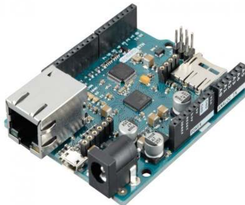
Figura 5.4: Arduino Leonardo ETH usado como unidade de controlo de I/O's
