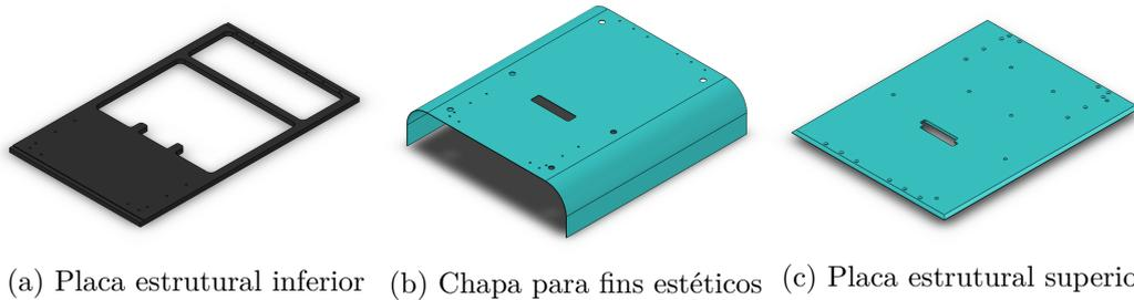
(a) Placa estrutural inferior (b) Chapa para fins estéticos (c) Placa estrutural superior
