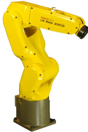
Figura 2.1: Manipulador FANUC LR Mate 200iD
