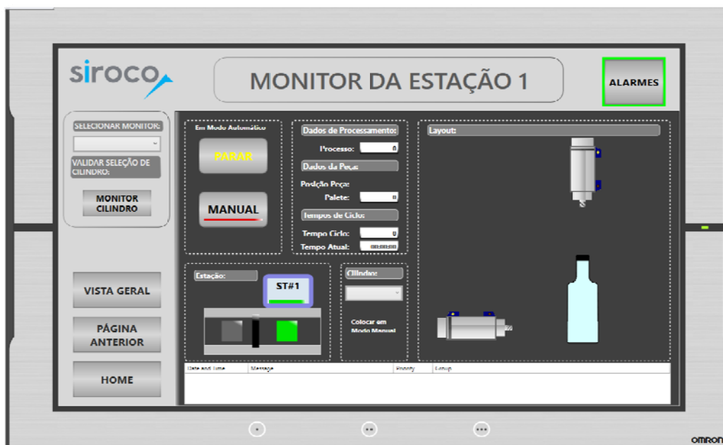
Figura 62 - Ecrã de monitorização e controlo da estação 1.
