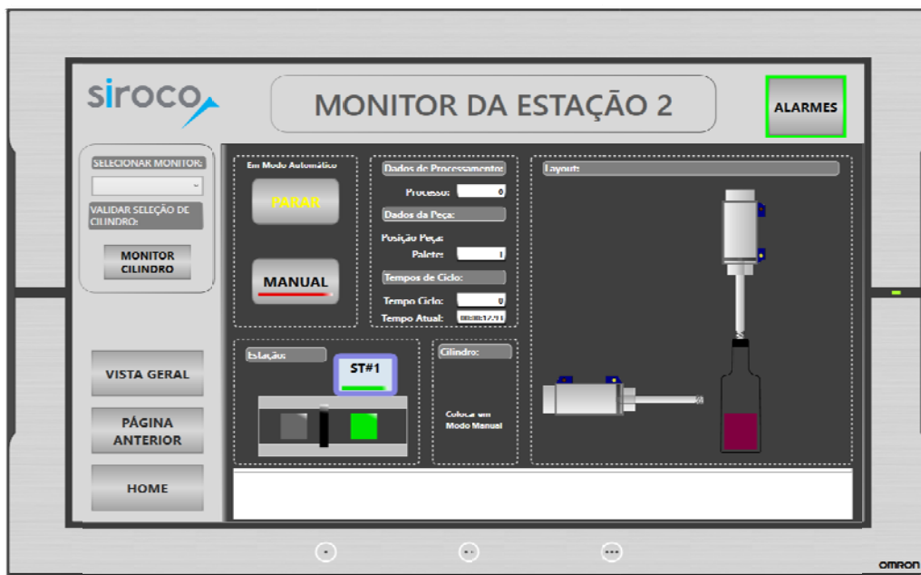
Figura 67 - Ecrã de monitorização e controlo da estação 1 - enchimento da garrafa.
