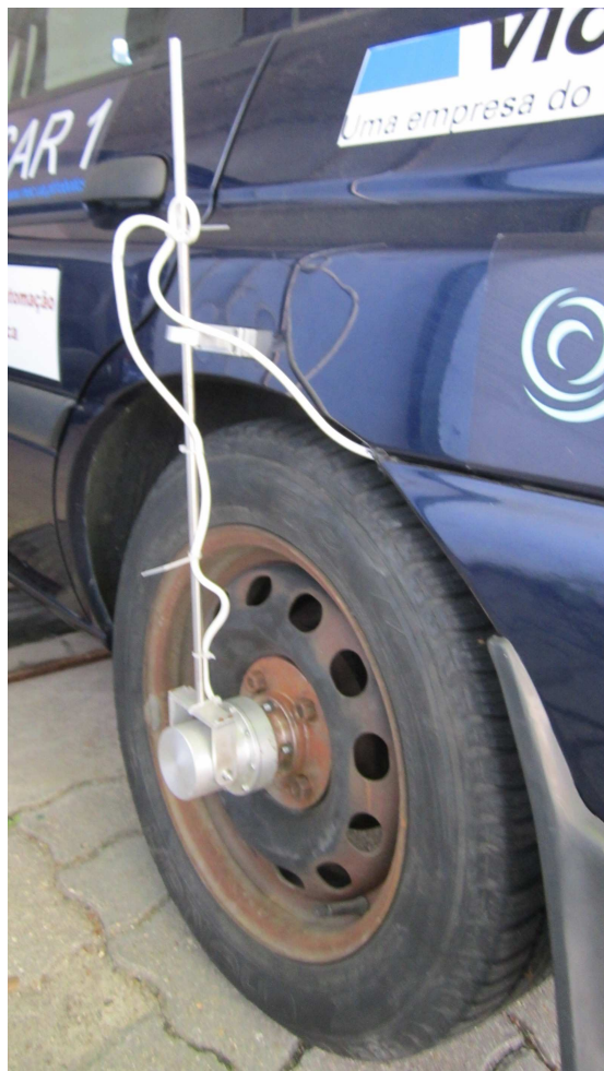
Figura 2.9: Suporte para encoder acoplado à roda lateral traseira do AtlasCar.
