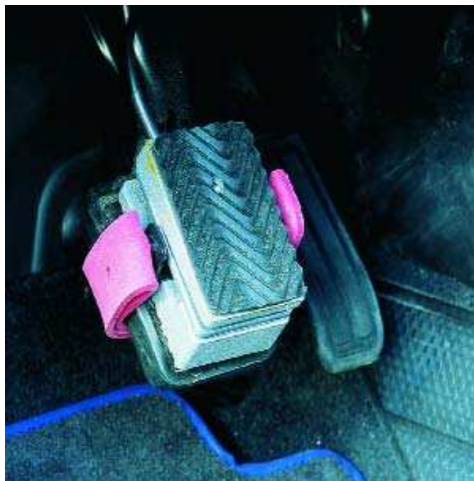
Figura 2.6: Sistema baseado numa célula de carga para medição da força aplicada no pedal.
