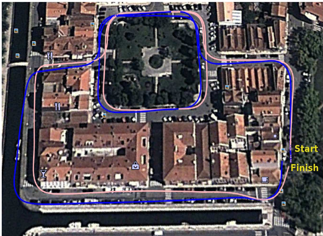
Figura 4.5: Representação da reconstrução do caminho calculado segundo o hodometria simples e segundo a fusão com o sensor inercial - Localização Alboi.
