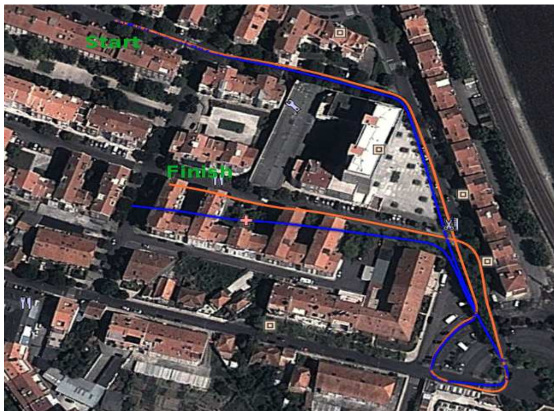
Figura 4.6: Representação da reconstrução do caminho calculado segundo o hodometria simples e segundo a fusão com o sensor inercial - Localização Bairro do Liceu - Aveiro.
