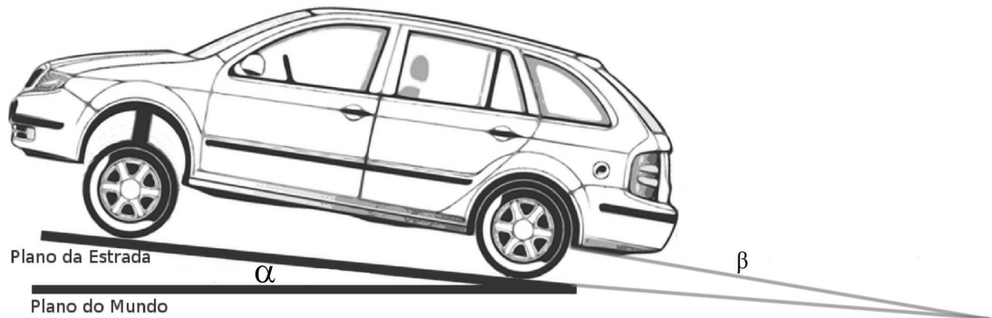
Figura 2.10: Esquema exemplificativo das diferentes inclinações presentes num carro.
