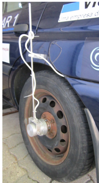
Figura 2.2: Encoder na roda esquerda do eixo traseiro.
