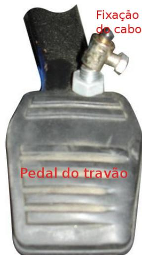
Figura 2.7: Fixação do cabo ao pedal do travão
