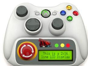
Figura 3.6: Protótipo inicial do comando E-Stop para integração no AtlasCar
