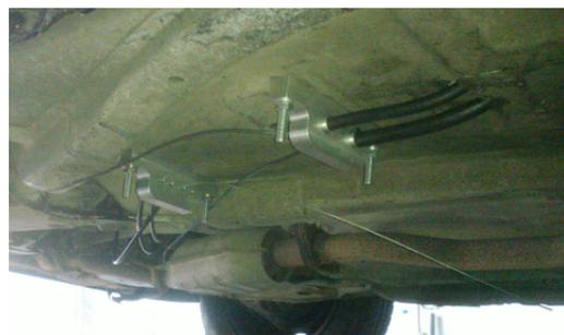
Figura 2.11: Sistema desenvolvido para recolocação das caixas de atuação
