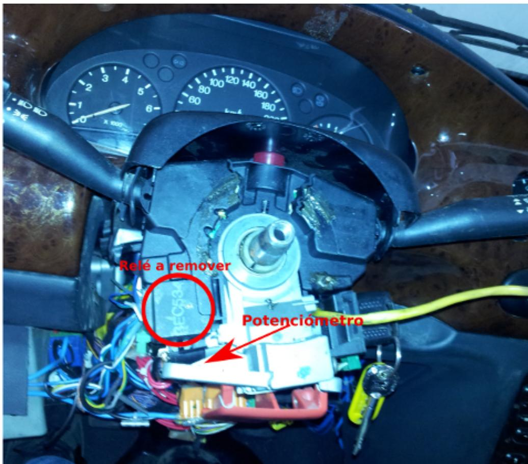
Figura 2.12: Esquema do novo posicionamento do potenciômetro de medição da posição do volante
