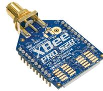
(b) Xbee Pro S2B rpsma
