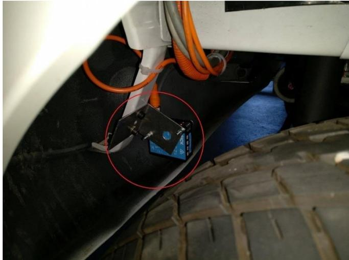
Figura 12-Posição dos sensores traseiros
