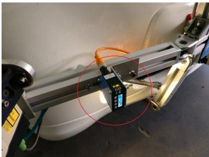
Figura 13-Posição dos sensores da frente
