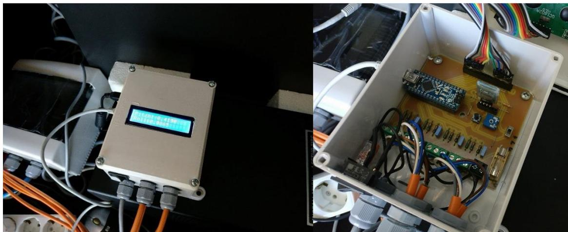
Figura 14-Caixa PVC com hardware, ligações realizadas e em função
