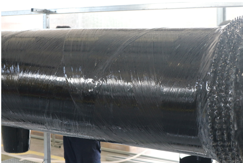
Figure 5. Promenor da superfície da peça durante o enrolamento do lado do braço robótico.
