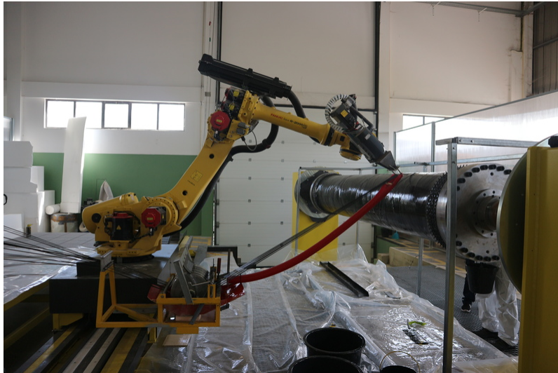
Figure 1. Setup do processo, com o braço robótico, o sistema de feeding e o torno com a peça.
