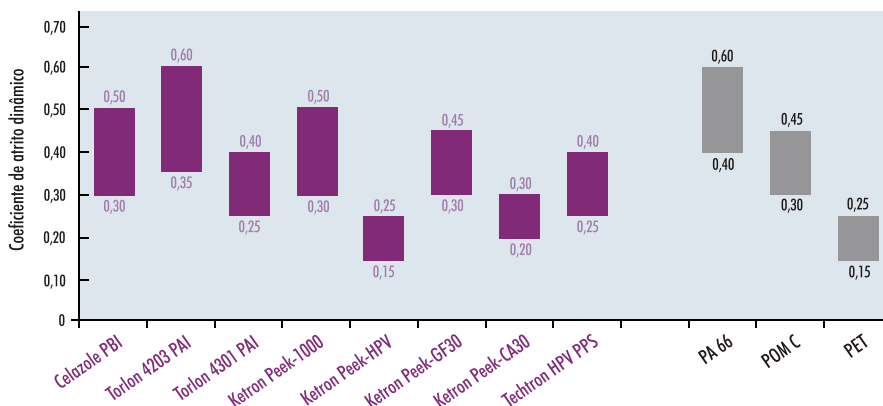
Coefficiente de Atrito Dinâmico a 23° C Medido através de uma vareta do material que roça sobre um disco de aço
