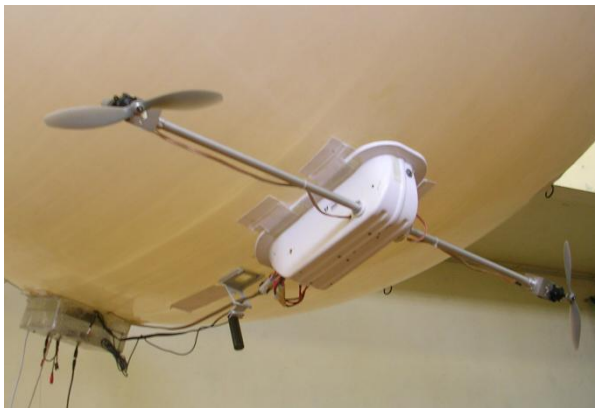
Ilustração 15 – Motores dianteiros e haste de suporte
