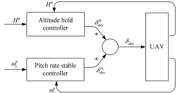
Fig. 5 Longitudinal controller
