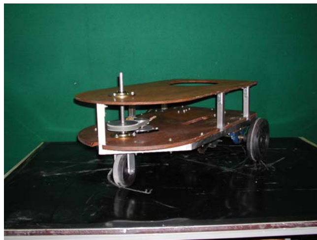
Figura 22 – Estrutura do robot em fase final de montagem.
