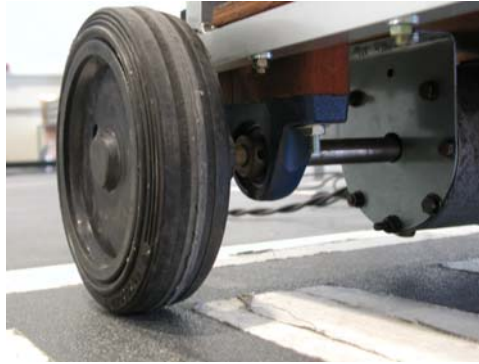
Figura 10 – Conjunto de um semi-eixo de tracção.
