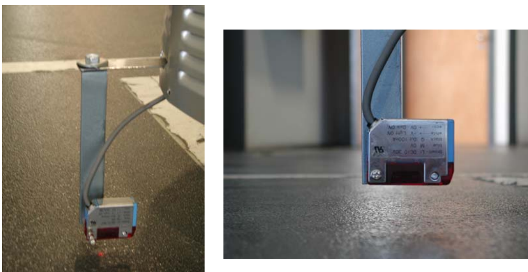
Figura 28 – Sensor da passadeira Sick WT170.
