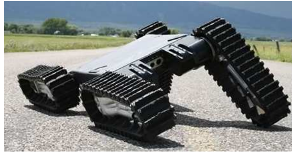
Figura 1.6: Exemplo de tracção por lagartas: Chaos da Autonomous Solutions.
