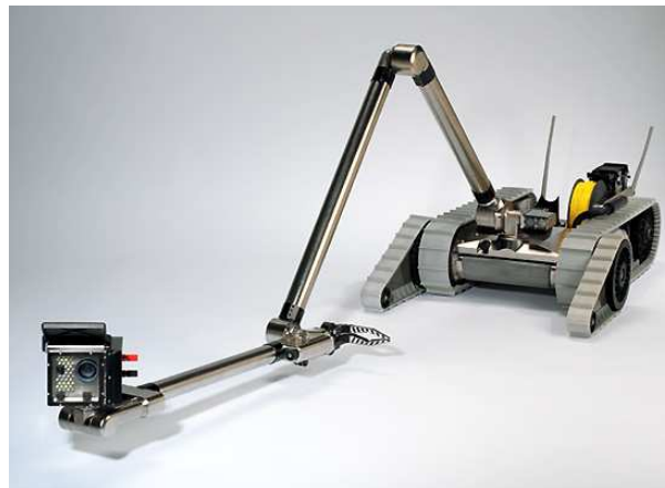
Figura 1.3: Robô de classe transportável: PackBot da iRobot
