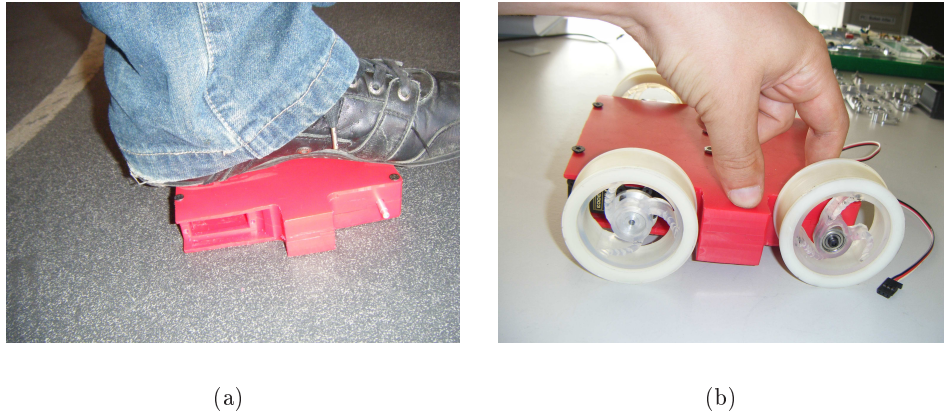
Figura 3.4: Fotografias dos testes de segurança passiva: carregamento da estrutura (a), deformação das rodas(b).
