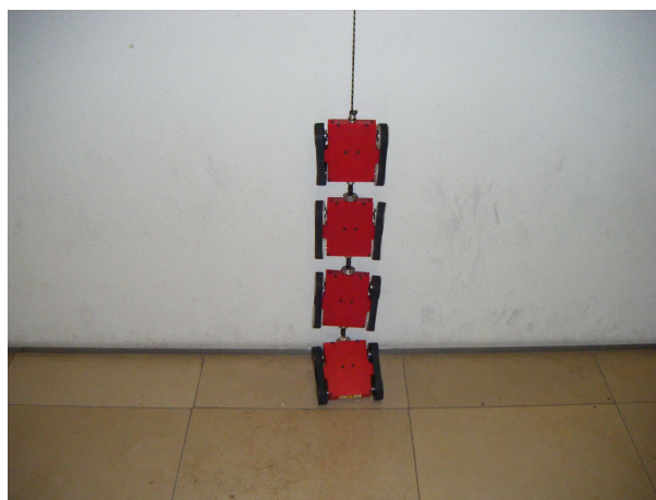
Figura 3.11: Fotografia do sistema constituído por quatro unidades em operação vertical, suspenso a descer uma parede.
