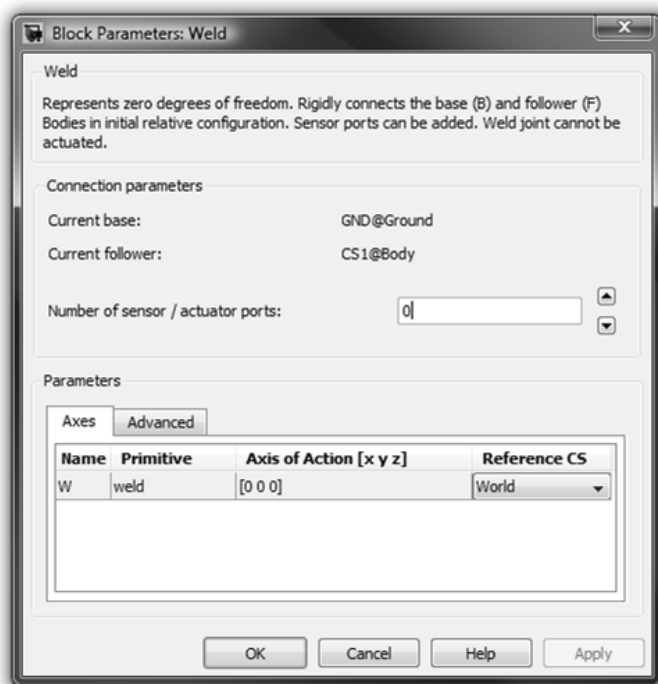
Figura A6 – Janela de configuração do bloco de “ Weld ”
