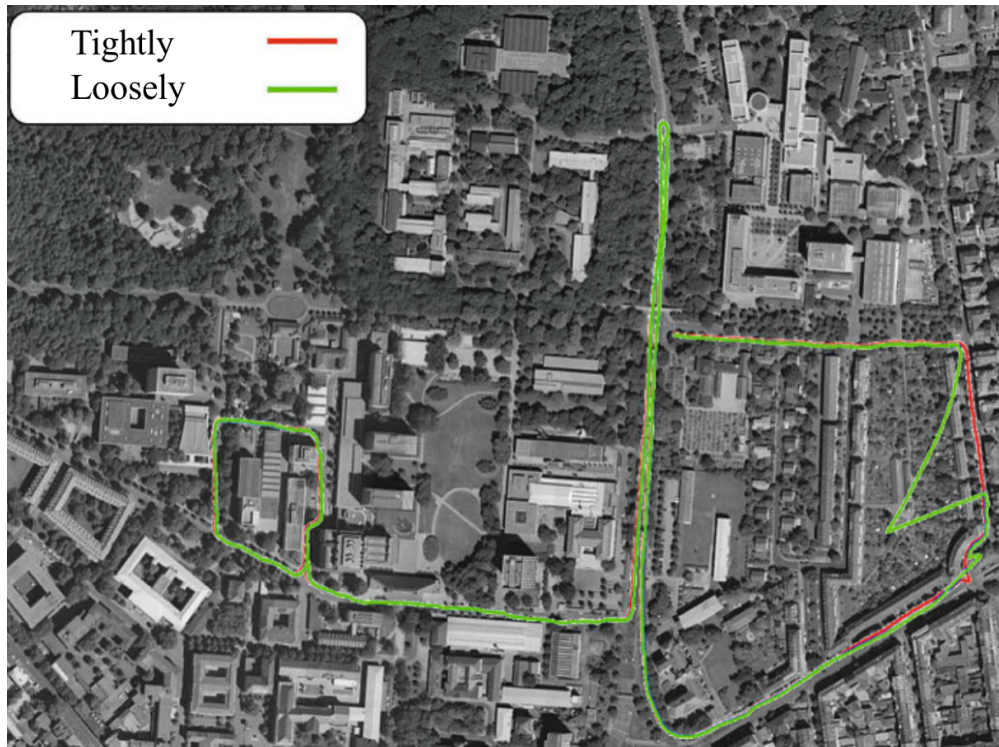
Figura 2.5: Comparação da ligação forte face à ligação fraca (Teunissen et al., 2017).
