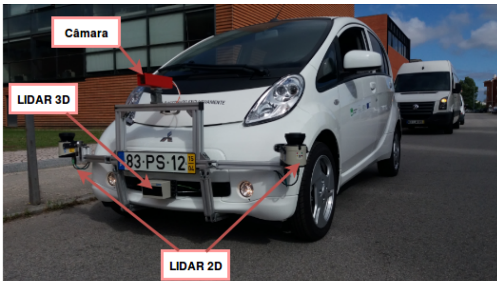
Figura 1.2: ATLASCAR 2 e localização dos principais sensores.
