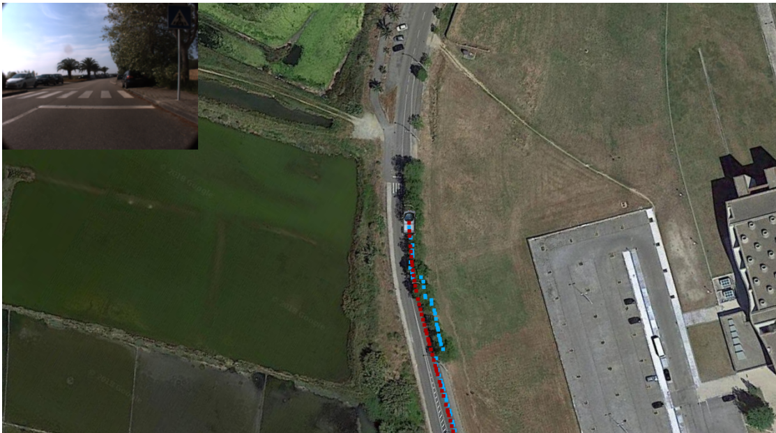
Figura 4.8: Representação na aplicação Mapviz da posição a vermelho utilizando a integração GNSS+INS e a azul a posição calculada através do sistema GNSS.
