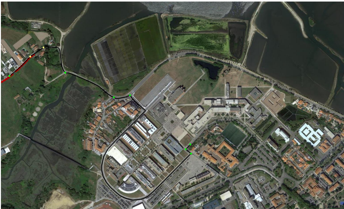
Figura 4.9: Exemplo do funcionamento do plugin global_planning , representando a preto os segmentos de retas definidos pelos waypoints , a verde as etapas do percurso e a amarelo os pontos que definem o segmento de referência para o veículo.
