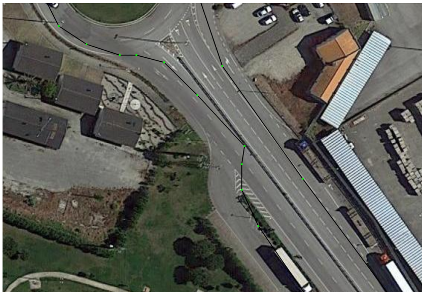
Figura 6.1: Situação e posicionamento errado dos waypoints .
