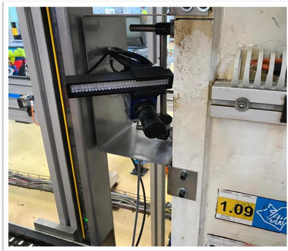
Sistemas de visão utilizando câmaras inteligentes e iluminação infravermelha
