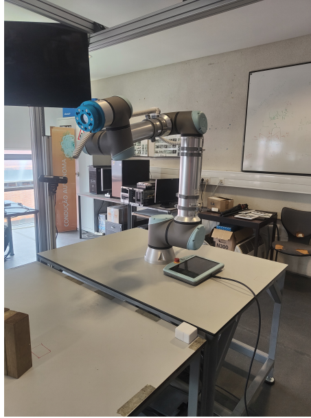
Figura 3.4: Braço robótico UR10 utilizado no projeto
