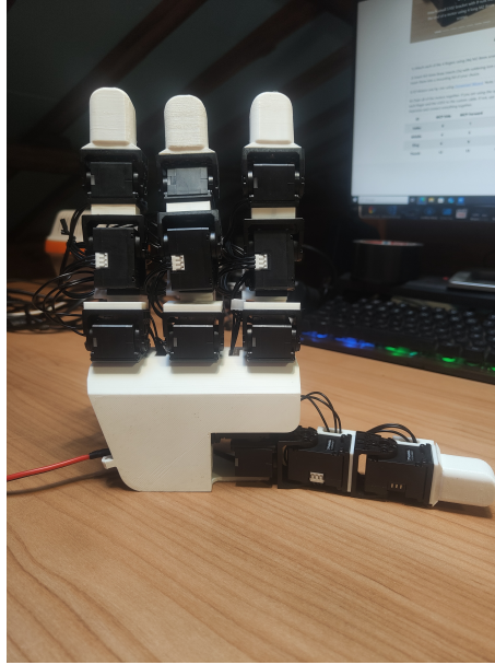
Figura 4.3: Mão robótica completamente montada, seguindo a estrutura proposta na documentação da LEAP Hand.
