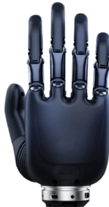
Figura 2.1: OceanTrix Hand desenvolvida pela OceanTrix Robotics[8].
