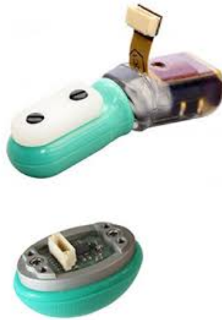
Figura 2.7: Sensor Biotac desenvolvido pela SynTouch [14].
